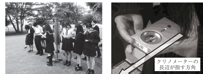
図3 地図を作る実習で、クリノメーターの長辺を次の地点に向けているようす
