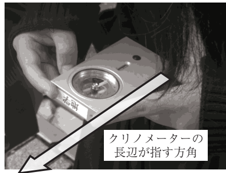
図14 地図を作る実習で、クリノメーターの長辺を次の地点に向けているようす
