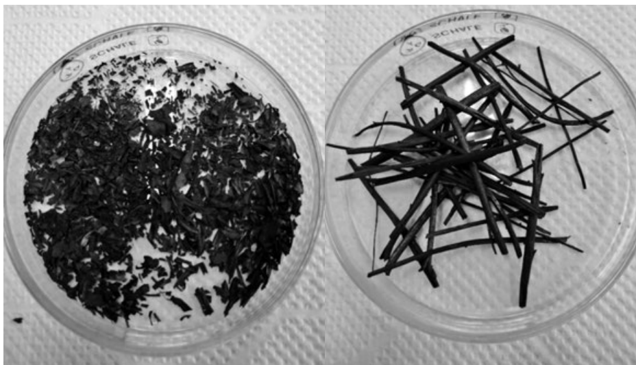
図1. 焼成処理後のモエジマンダの葉および茎バイオチャー 左:葉バイオチャー、右:茎バイオチャー
