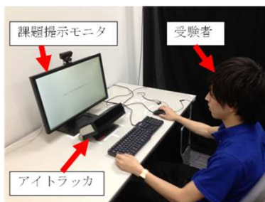
視線追跡装置を利用したカンニング検出システム
