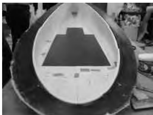
図10 加工したコア材をメス型に配置
