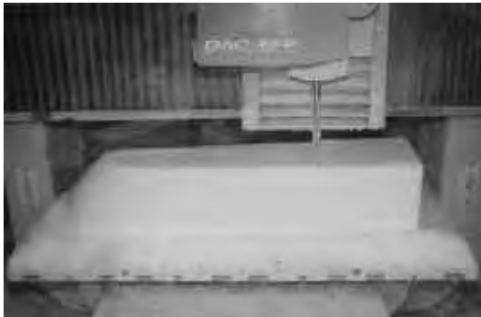
図5 3Dモデラマシンの加工風景
