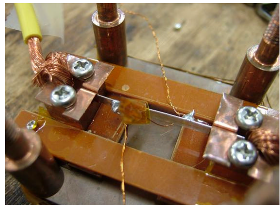
Fig.2: 線材(非断熱状態)
