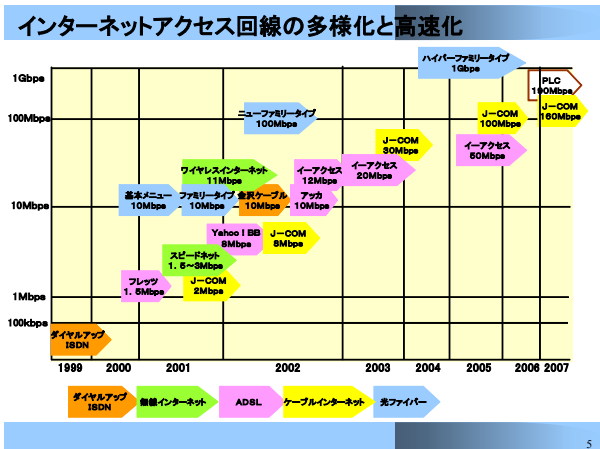
図6 有線系での高速化の歴史(ADSL, 光ファイバ, CATV, PLC)
