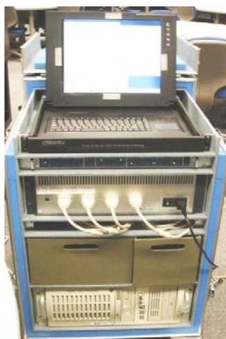
図2 JPEG2000 信号変換部
