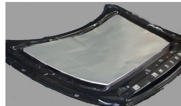
写真3. 繊維系吸音材にアルミ多孔箔を重ねたフードインシュレータ (7)
