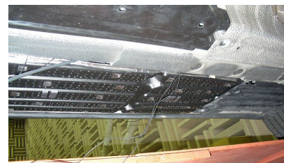
写真4. 内部に微細多孔板を組み込んだアンダーカバー(下面から) (7)
