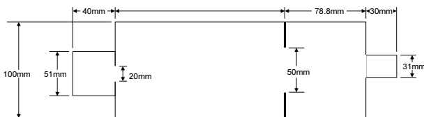
図34 2009年度大会用マフラー構造概要図
