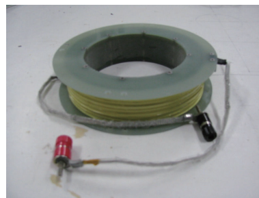
図 8. 酸化物超伝導コイル (臨界電流 32A: 住友電工製)
