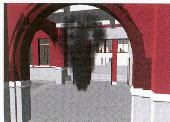
図3 煙のリアルタイム可視化
