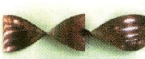
図2 Eversion mechanismを有する乱流促進体
