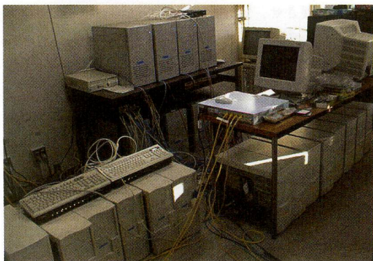
ギガビットイーサ結合のPCクラスタシステム
