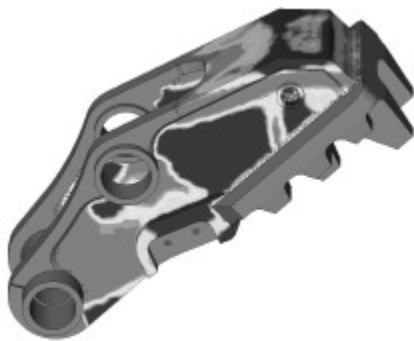
図8 最適設計解析結果 (V=50%)
