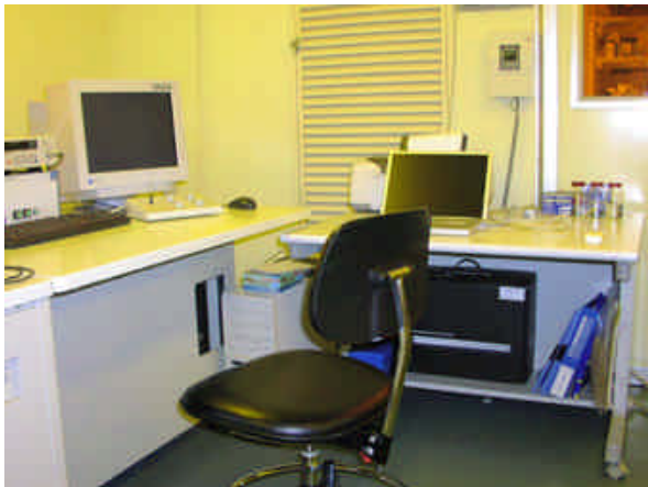
図2 電子顕微鏡操作モニターと描画装置の作図用モニター。右のモニター上で図形の作図からレジストへの描画条件の設定、描画作業までを制御することができる。
