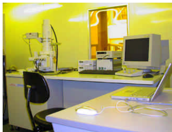
図 1 電子線描画装置の鏡筒部分。左側の筒状部分が電子顕微鏡の鏡筒で、下部にサーボ制御されたステージが置かれている。中央部はビーム制御用エレクトロニクス。右が電子顕微鏡のモニターおよび制御卓。
