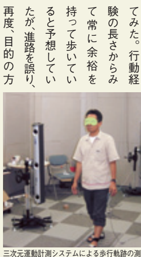
三次元運動計測システムによる歩行軌跡の測定
